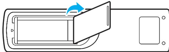
2. Legen Sie zwei Batterien mit der richtigen Polarität (+/-) entsprechend der Kennzeichnung im Batteriefach ein.
